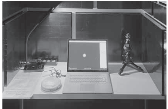
写真1 AMM-CBが設置されたブース内 ブース内壁の黒いブロック状のものがAMM-CB
